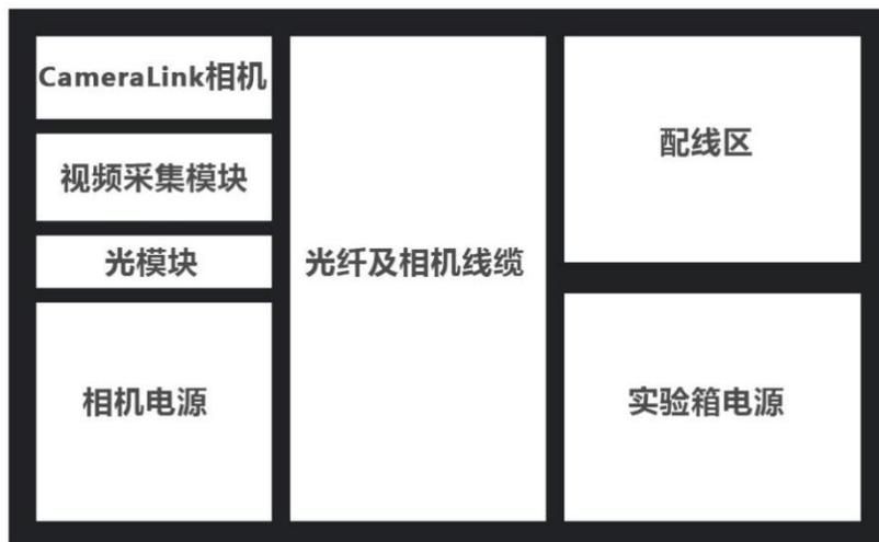
图 10 TL6678F-TEB 实验箱配件区结构图
