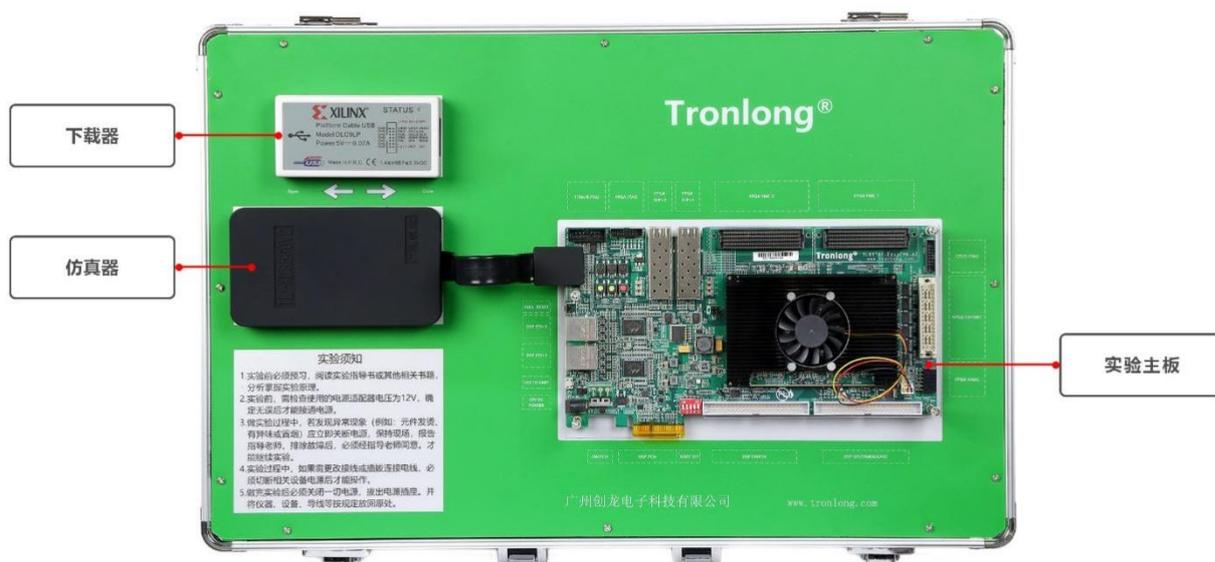
图 9 TL6678F-TEB 实验箱结构图
