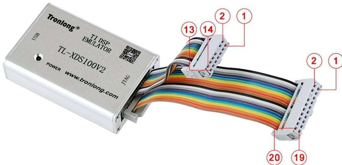
图 4 20-20-14pin JTAG 转接排线
