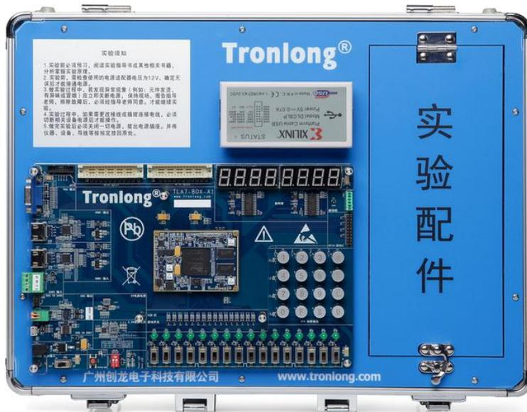
图 3 TLA7-TEB 实验箱主体正面图
