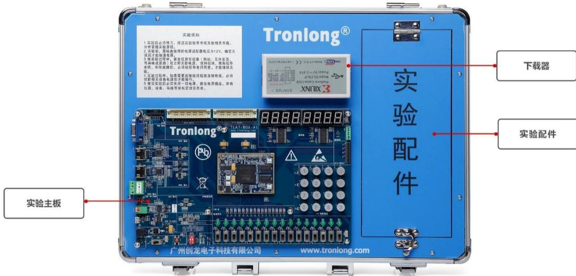
图 8 TLA7-TEB 实验箱结构图
