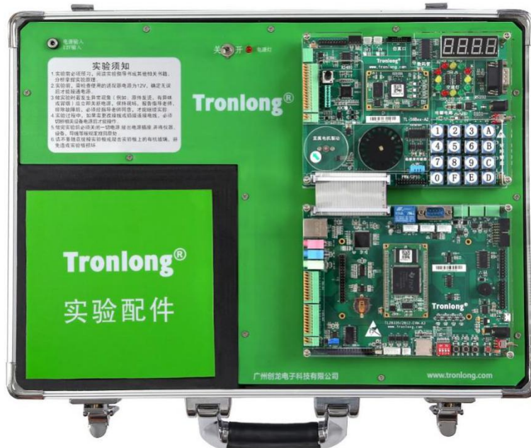
图 3 TL28335F-TEB 实验箱主体正面图
