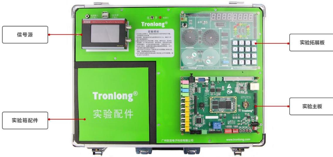
图 12 TL6437-TEB 实验箱结构图
