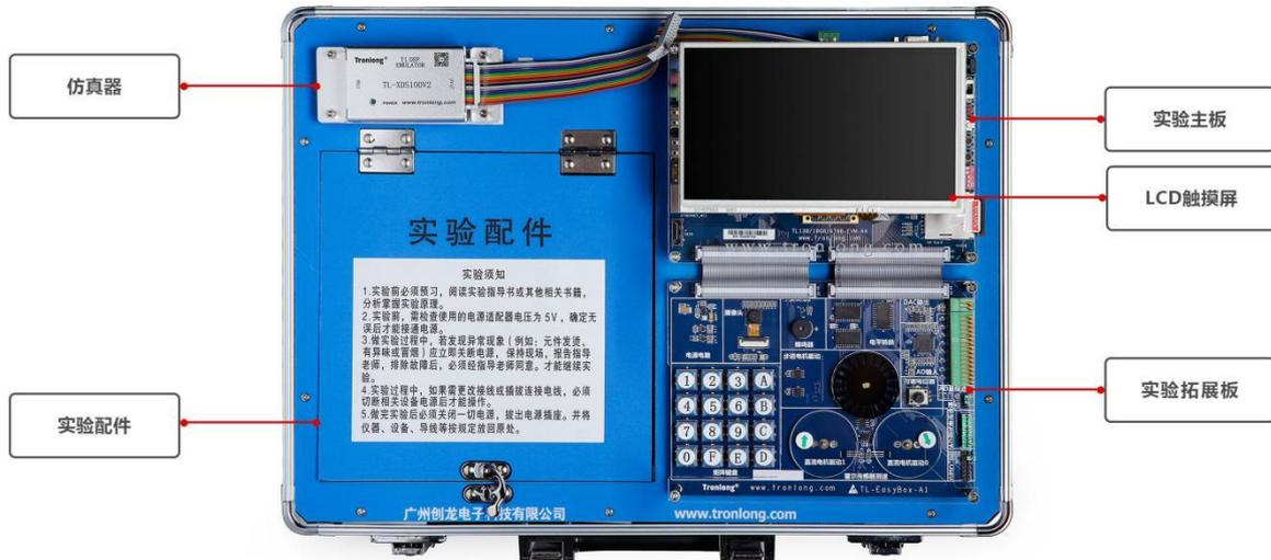
图 11 TL138-TEB 实验箱结构图
