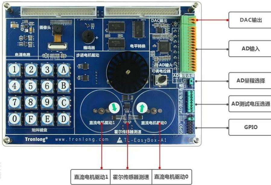
图 9 实验拓展板硬件资源图解 1
