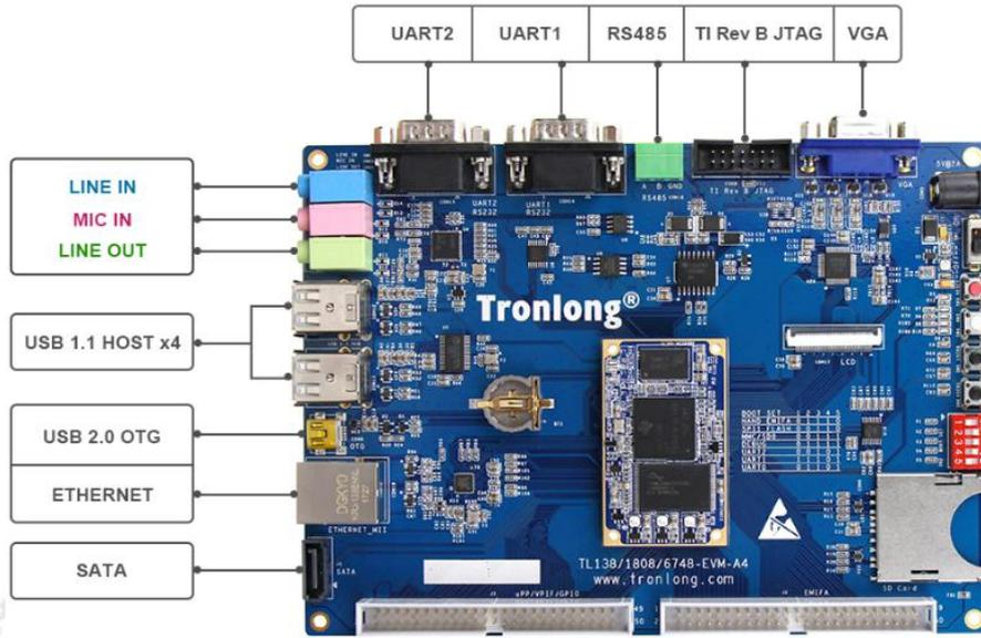
图 7 实验主板硬件资源图解 1
