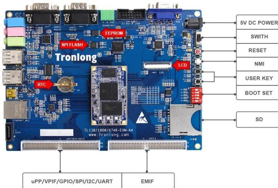
图 8 实验主板硬件资源图解 2
