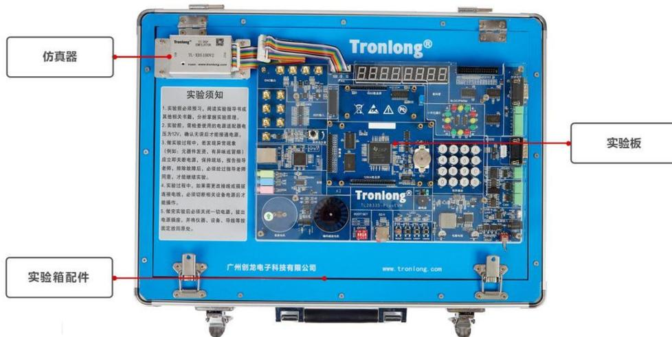
图 7 TL28335-PlusTEB 实验箱结构图
